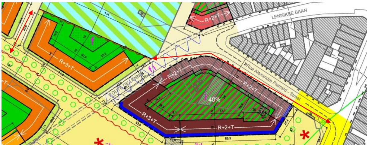
Figuur 4-5 : Alternatief 2 – aanpassing voetgangersverbinding (rode pijlen) bij behoud site De Lijn in zijn huidige vorm (Bron : Schema van de Bestemmingen BBP "Klaverwijk").
