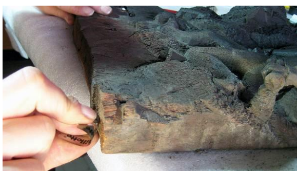
Fig. 19. Préparation d'un chemin de mesure dendrochronologique à la lame de rasoir sur la base d'un relief sculpté de retable © P. Fraiture, Labo. Dendro., IRPA
