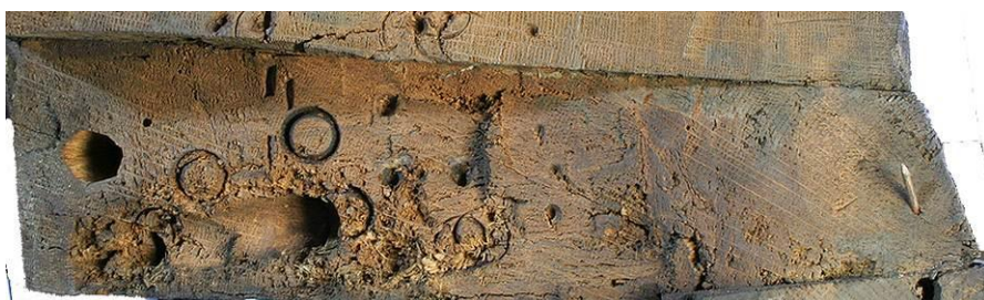
Fig. 13. Base d'un relief sculpté de retable comportant des traces d'outils du travail du bois et d'établi qui compliquent fortement la lisibilité des cernes de croissance © P. Fraiture, Labo. Dendro., IRPA
