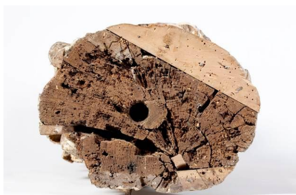
Fig. 11. Bases de sculptures endommagées sur lesquelles un enregistrement dendrochronologique n’est pas réalisable. © IRPA
