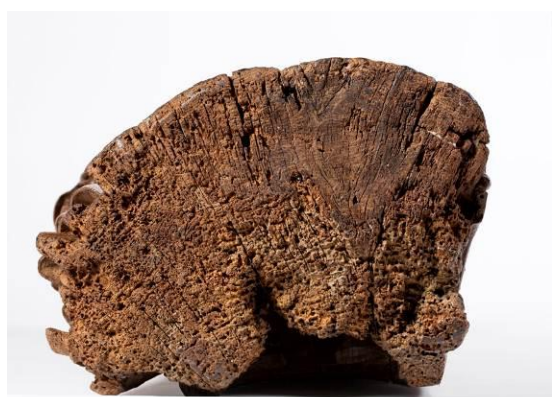
Fig. 11. Bases de sculptures endommagées sur lesquelles un enregistrement dendrochronologique n’est pas réalisable. © IRPA
