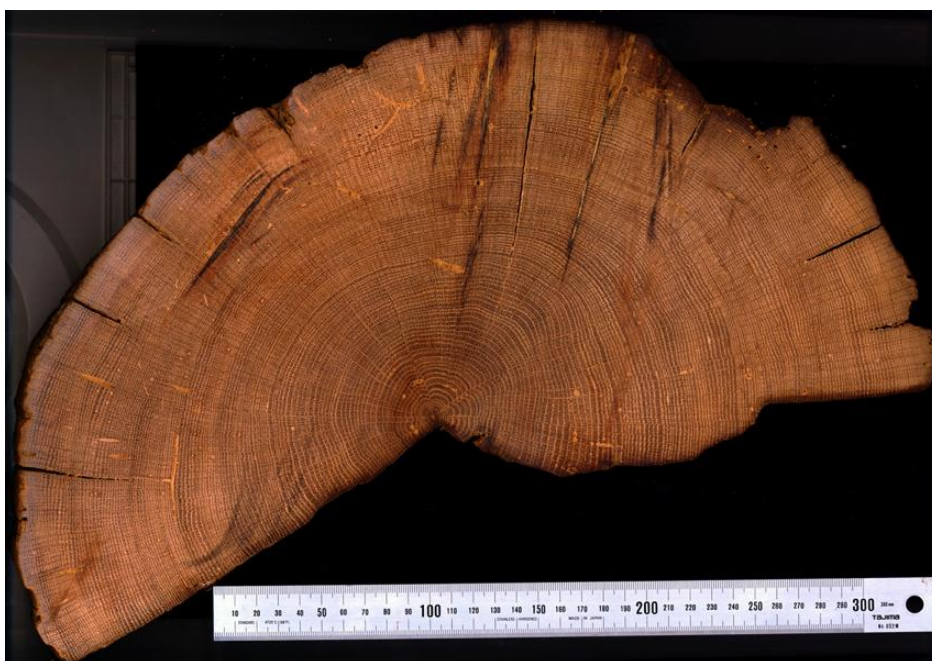
Fig. 39. Scans des trois rondelles débitées des pièces de chêne conservées dans le comble, poncées en vue de l'examen dendrochronologique © Labo. Dendro., IRPA
