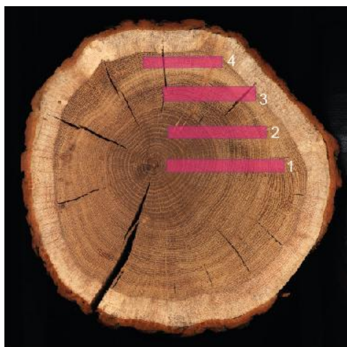
Fig. 8. Schéma de la section transversale d'un tronc de chêne montrant les différentes orientations de débitage des planches :
