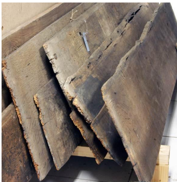
Fig. 12. Planches de fond d'un retable démontées pour restauration : leurs chants étant fortement endommagés, les cernes de croissance ne sont que partiellement exploitables © P. Fraiture, Labo. Dendro., IRPA
