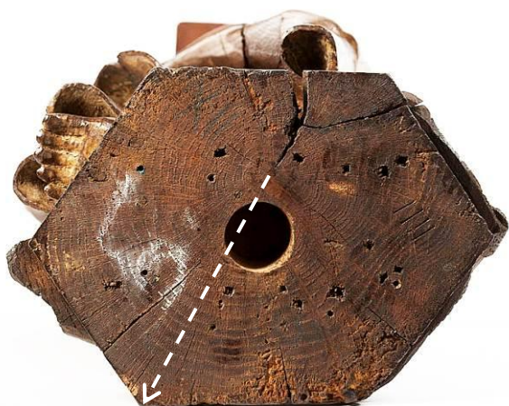
Fig. 2a. Cernes accessibles sur la base d'une sculpture (la flèche figure la direction d'un chemin de lecture dendrochronologique, du cœur vers la périphérie) © IRPA
