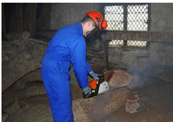
Fig. 38. Tronçonnage d'une rondelle de chêne dans le comble © Labo. Dendro., IRPA
