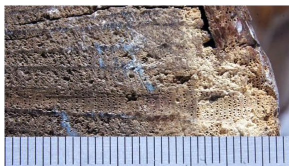
Fig. 20. Chemin de mesure préparé à la lame de rasoir, nécessaire en particulier pour l'aube très friable © P. Fraiture, Labo. Dendro., IRPA
