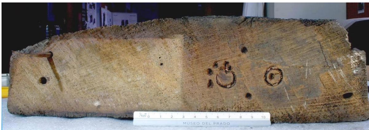
Fig. 30. Base d'un relief sculpté de retable, réalisé dans une des plus grosses pièces de chêne balte rencontrée : un quartier de grume débité par fendage d'une dizaine de centimètres d'épaisseur et d'une trentaine de centimètres de largeur. © P. Fraiture, Labo. Dendro., IRPA
